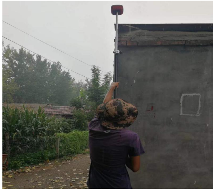
图 1 GPS-RTK 测量界址点
