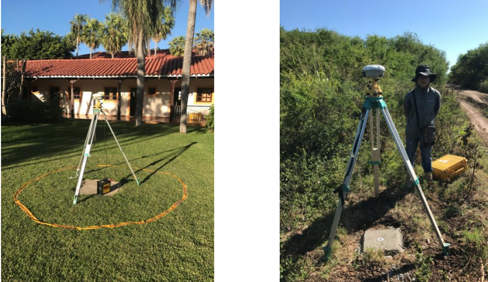
图 3-3 GNSS 卫星定位静态观测
