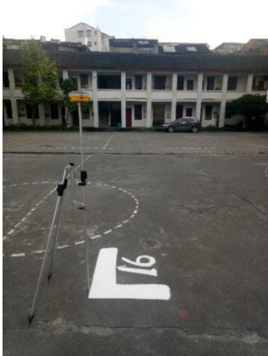
图 4 像控点现场测量示意图
