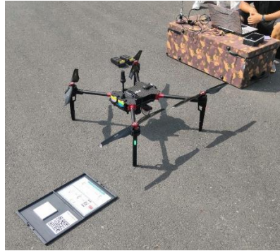
图 1 飞马 D200 无人机起飞前准备及辐射定标
