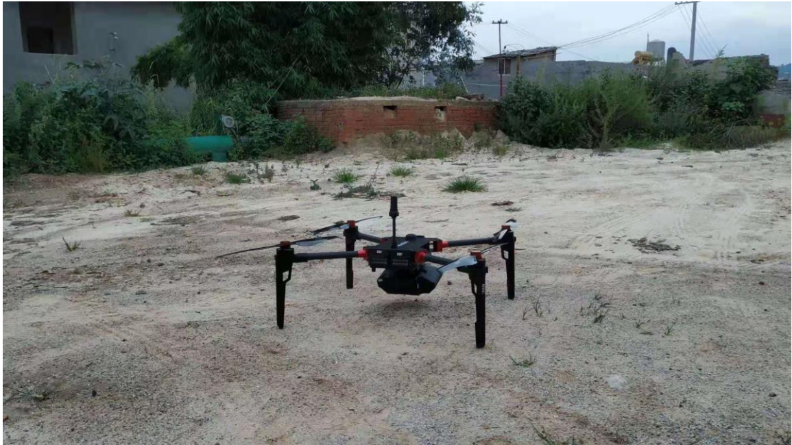
图 5 四旋翼航测无人机 D200 搭载 D-0P200 (5*RX0) 五相机
