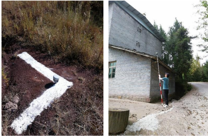
图 3 像控点布设及测量
