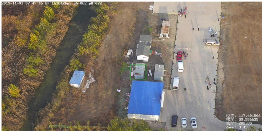
通过无人机管家地图确定目标位置，开启 GPS 环绕功能，选择合适的环绕高度及半径，并在视频中框选环绕目标进行修正同时在一定范围内变焦观察目标细节，实现目标的全方位观察。
