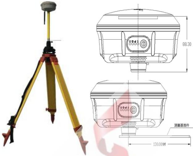
(2) 如果没有已知点坐标信息,只要按照上面步骤进行基准站架设,然后通过设备点采集功能获取该点坐标信息,可按照(1)中规定的方法计算垂高后写入无人机管家,再次使用该点时可直接调用该已知点坐标信息。
