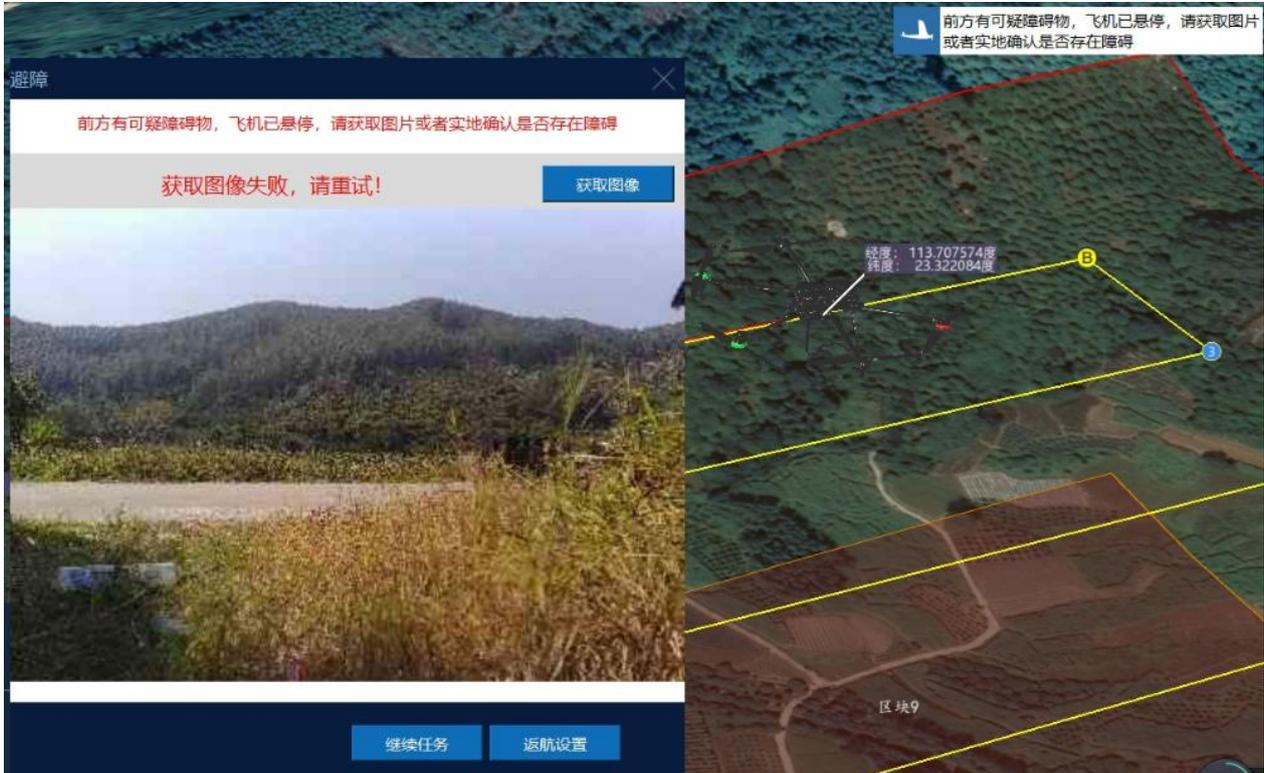
图二 避障第二阶段，获取障碍物影像+飞手选择下一步操作
