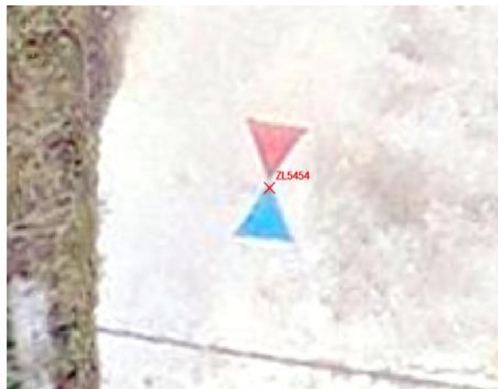
像控点实测坐标与DOM像控制点点之记的坐标值之差小于2.0cm
