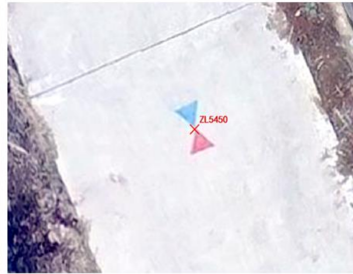
像控点实测坐标与DOM像控制点点之记的坐标值之差小于2.0cm
