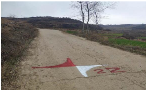
图 6 像控点检核点布设
