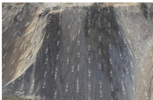
图 13 EPS 提取高程点
