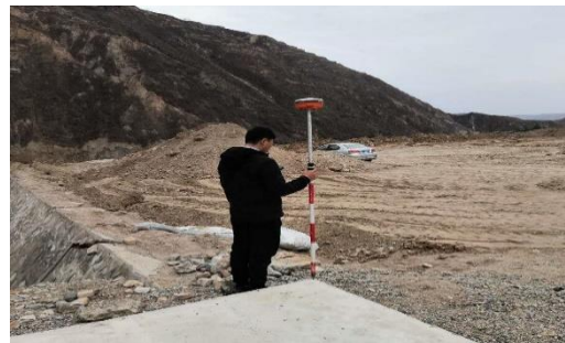
图 7 像控点检核点测量
