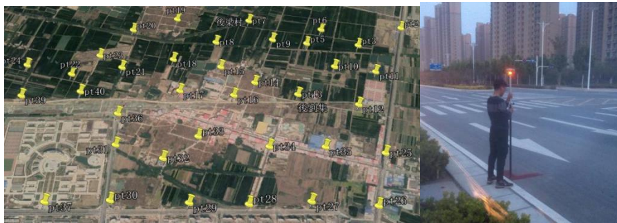
图5 像控点示意图（左：奥威上点位，右：实地测量点位）
