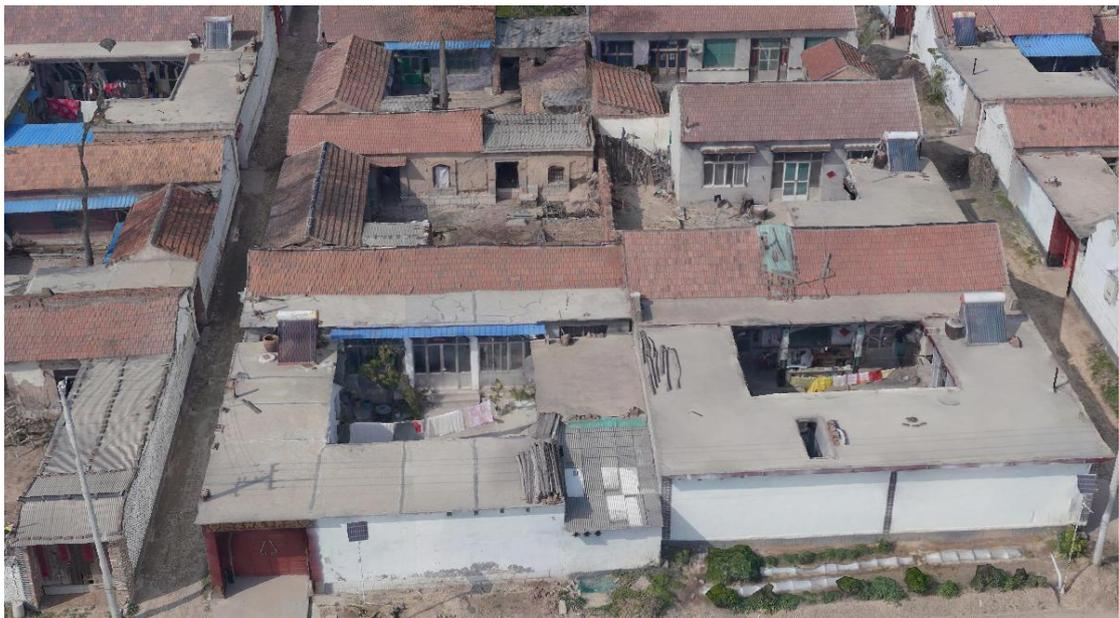
6、精度检测。为准确验证三维模型精度，检查模型成果能否满足地籍测量中误差 5cm 的精度要求，使用省网 rtk 作业模式，实地测量房屋角点坐标 31 个，用于模型精度比对。
