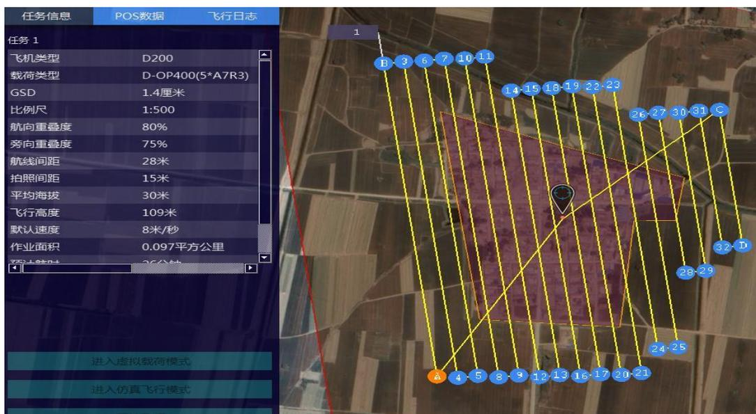
4、pos 解算及数据整理。使用飞马无人机管家智理图、智拼图模块完成 pos 解算，并按照 smart3D 软件要求，对影像和 pos 数据进行整理。
