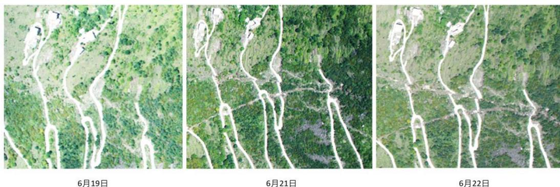
图 6 19-21 日滑坡后缘裂缝动态变化示意图
