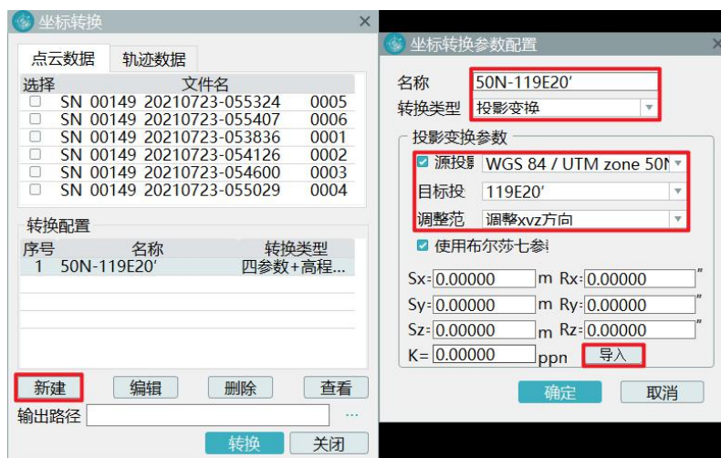
图 投影变换坐标转换设置
