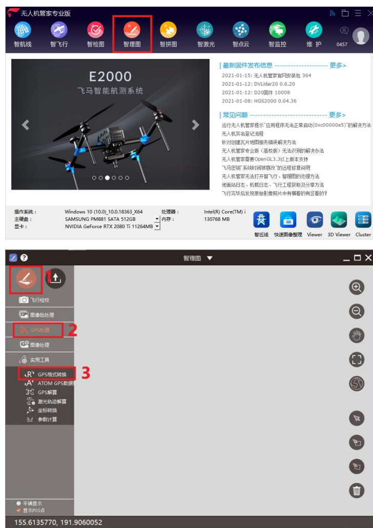
图 智理图 GPS 格式转换入口
