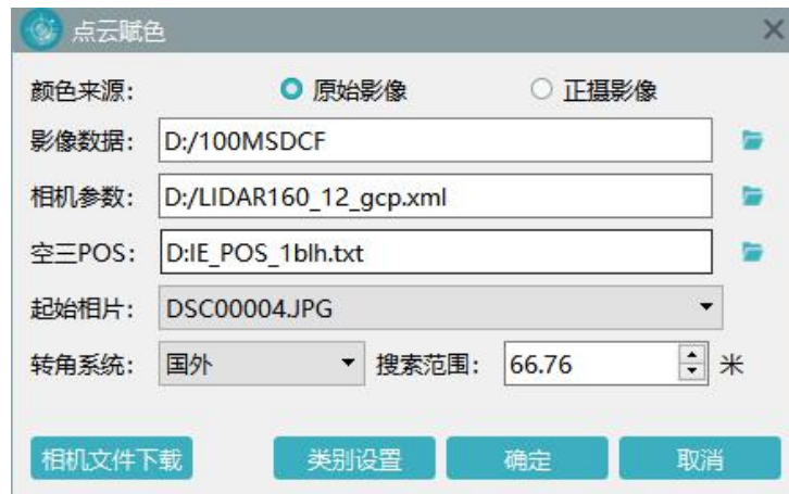
图 基于原始影像进行点云赋色
