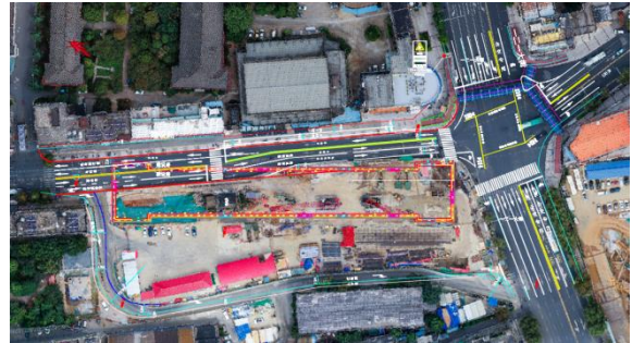
图 2 交通疏解及施工平面布置（一期）
