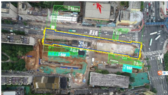
图 1 车站主体及附属平面布置
