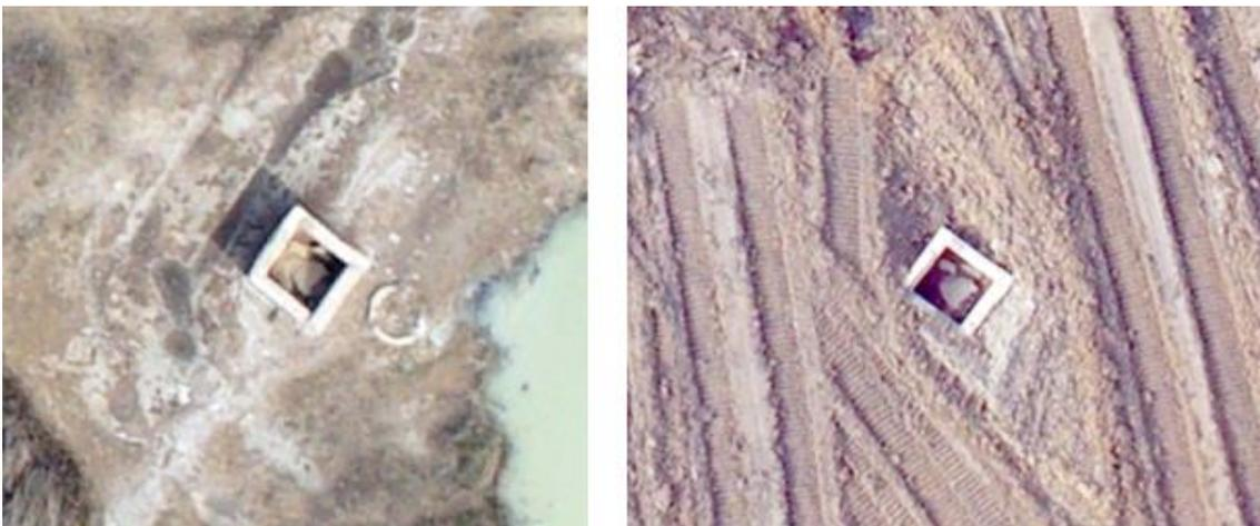
图 10 井壁破损对比图
