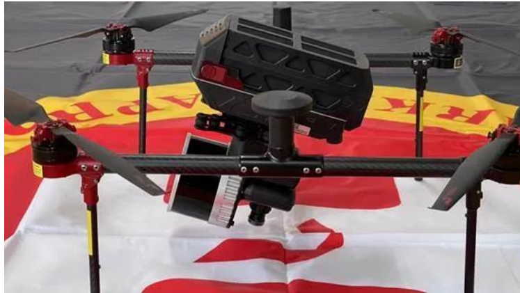
图3 飞马 D2000 搭载 Lidar3000 激光测量系统
