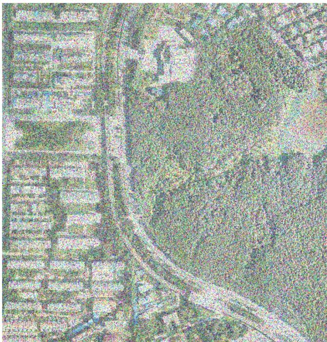
图7 无人机航测数据中去噪前(加入高斯噪声与椒盐噪声)
