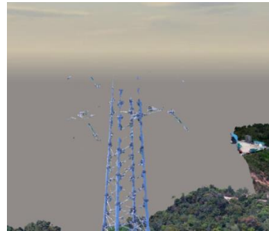
图 9 高压线塔模型塔顶部分缺失
