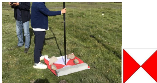
图 4 像控点布设（预制标靶）
