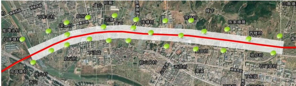
图 10 5KM 像控点位分布示意图
