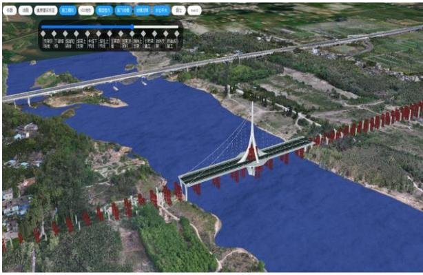
图7 倾斜摄影与 BIM 融合模拟施工阶段
