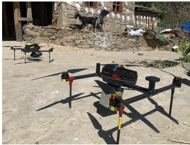
图 2 飞马 D2000 航测系统 + D-OP3000/D-LiDAR2000
