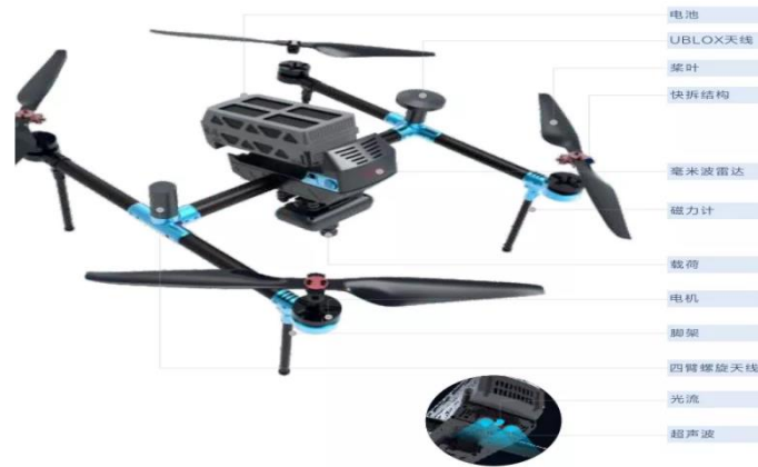
图2 E2000 无人机结构图 Fig2 E2000 UAV structure diagram
