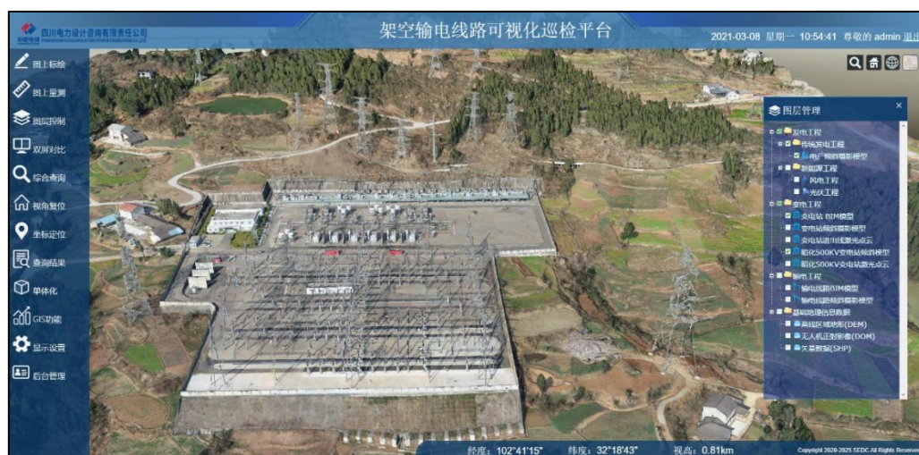
图 13 三维模型可视化巡检平台
