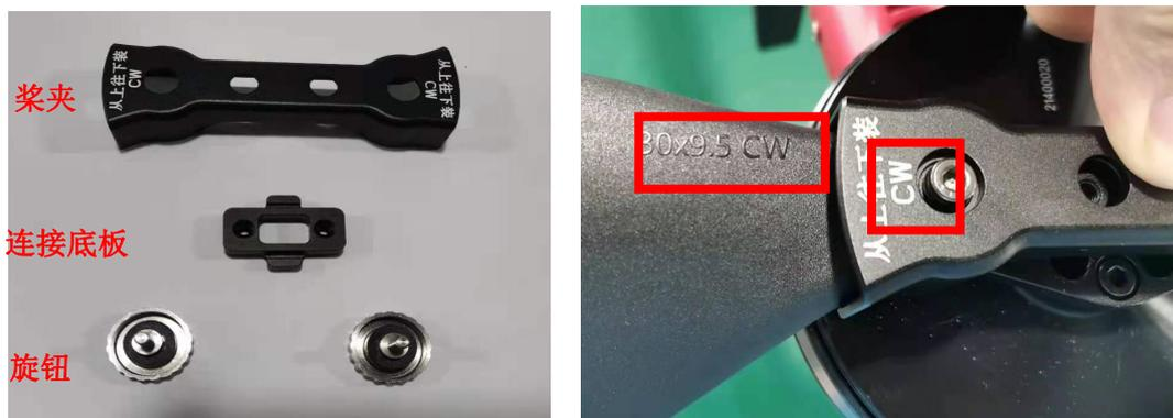
2、将连接底板螺丝孔对准桨夹孔，然后将两个旋钮锁紧用以固定桨叶，效果如图所示。
