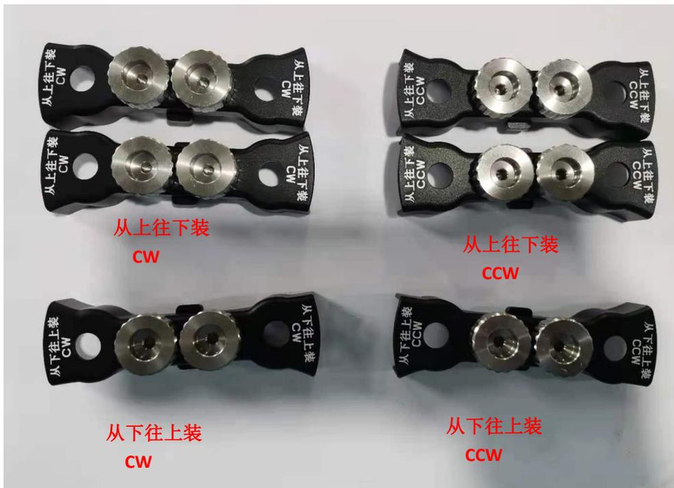
飞机上电前，需安装桨夹，固定桨叶后方可进行飞行作业。按照上图，1#支臂桨叶使用“从上往下装 CW”桨夹进行固定；2#支臂桨叶使用“从上往下装 CCW”桨夹进行固定；3#支臂桨叶使用“从上往下装 CW”桨夹进行固定；6#支臂桨叶使用“从上往下装 CCW”桨夹进行固定。4#和 5#支臂电机朝下，使用“从下往上装”的桨夹固定桨叶，**桨夹标识号(CW 或 CCW)需与桨叶标识号(CW 或 CCW)一致**。6 个桨夹安装方式一致，下面以 3#支臂桨夹安装具体进行说明。
