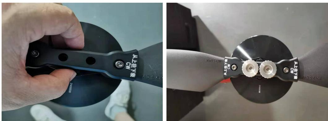
3、其他桨叶按照此方式安装桨夹（注意对应桨夹型号安装），桨夹安装后如下图所示：
