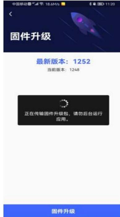
1.4 传输完成后, 点击确认, 此时请等待 35s 后再手动重启设备, 重启设备后等待设备指示灯白灯闪烁转为绿灯常亮, 此时固件更新成功, 可以正常使用设备。
