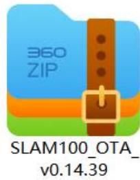
2.2 将新固件拷贝到内存卡的 OTA 文件夹内，注意：使用原装内存卡，不用解压固件，不用改变固件名称，有时微信传输文件可能固件名称后面会多一个（1）等，注意保持固件原有的名称。
