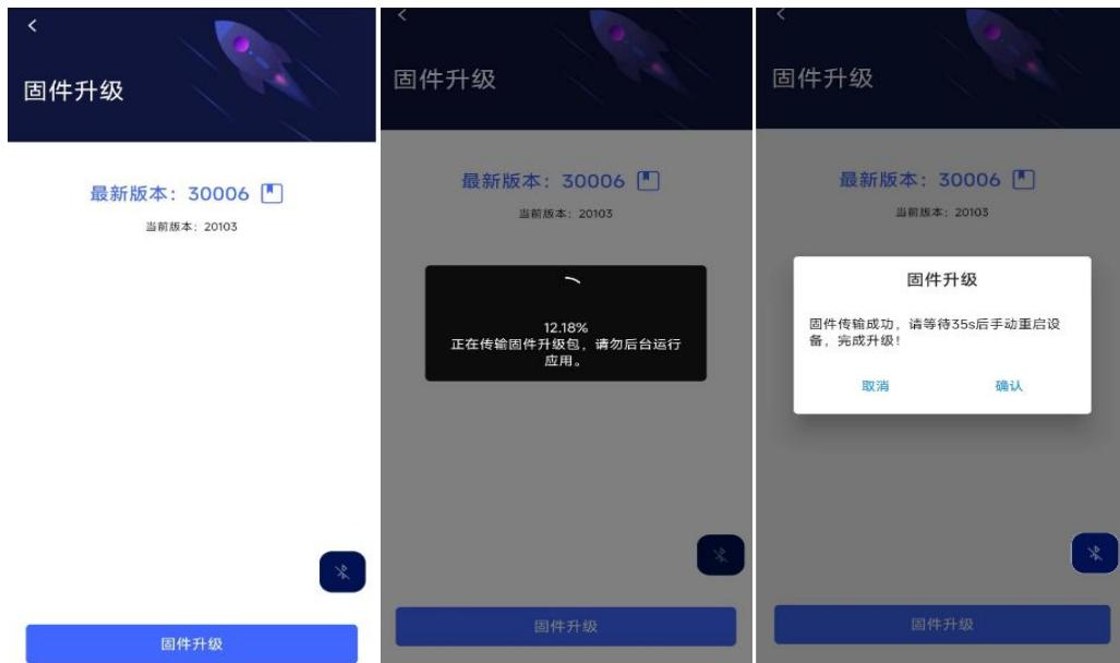
1.3 35 秒后，重启 SLAM2000，白色指示灯闪烁代表 SLAM2000 正在升级，根据每个版本升级包的大小不同，升级时长会有所差异。升级过程中不可操作扫描仪，升级完成后(绿灯常亮)，会看到 SLAM2000 激光头开始转动，停止转动后等待 10 秒重启 SLAM2000。
