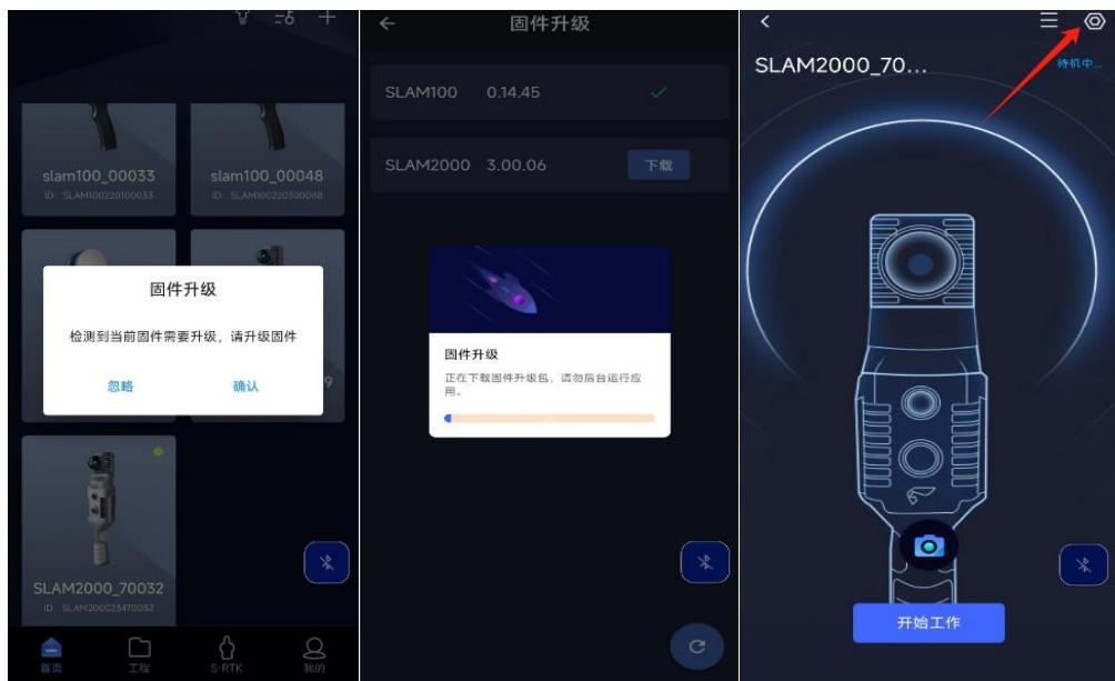
1.2 点击固件升级，软件会提示正在传输固件，待传输完成后，软件提示：固件传输成功，请等待 35S 后手动重启设备，完成升级。
