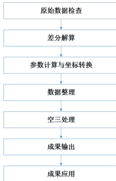
图 正射数据处理技术路线
