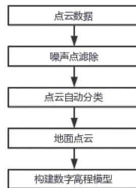
图4 点云分类流程图
