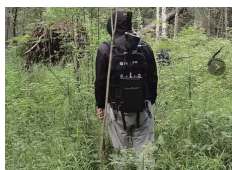
图7 背包式激光雷达扫描作业图
