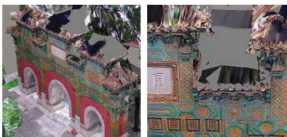
图9 基于地面近景影像的“琉璃牌坊”三维模型
