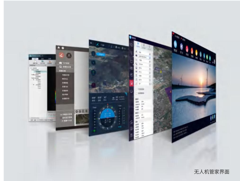
“无人机管家专业版”是无人机数据获取、处理、显示管理以及无人机维护的一站式智能GIS系统，支持固定翼、旋翼等种类丰富的飞行平台，满足各种应用需求的航线模式，支持真三维地形数据的精准三维航线规划、三维实时飞行监控、快速飞行质检，具有丰富的数据预处理工具箱，支持稳健的精度控制和自动成图、丰富的4D和三维成果生产，具有可视化监控中心，提供系统升级、智能维护、信息推送等云服务。
