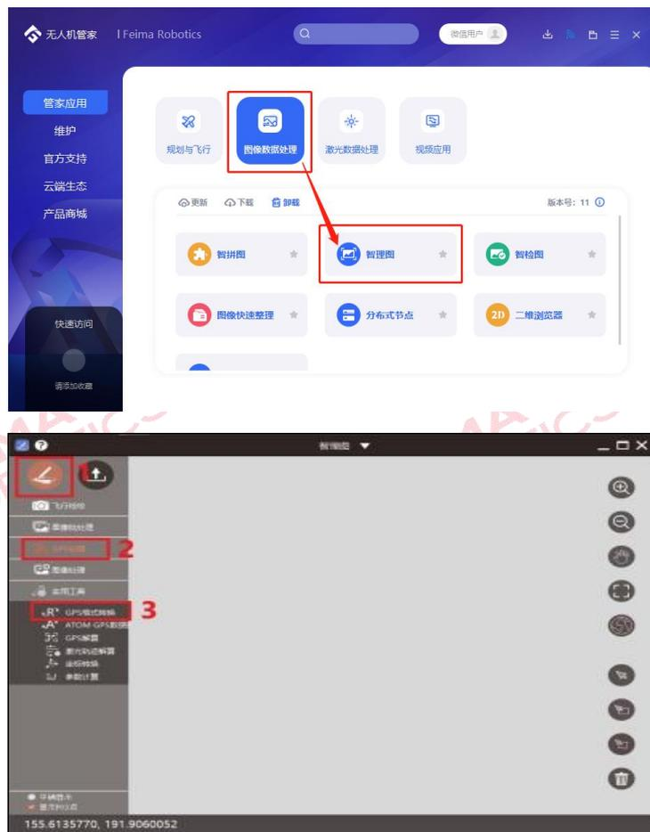
图 智理图 GPS 格式转换入口
