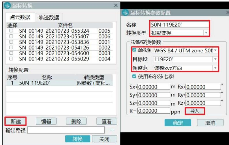
图 投影变换坐标转换设置
