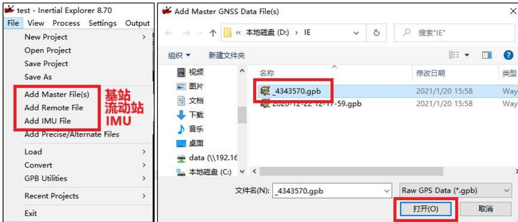
图 添加格式转换后的基站数据
