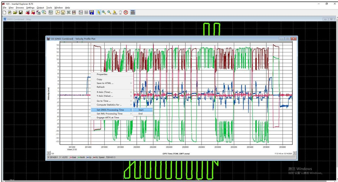
5) 鼠标右键点击降落时刻区域，出现红线，然后右键【Set GNSS Processing Time】- 【End】，设为终点。
