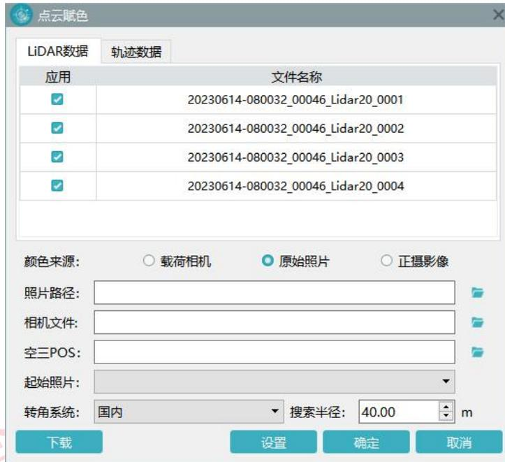
图 基于原始影像进行点云赋色
