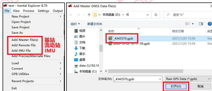
图 添加格式转换完的基站数据
