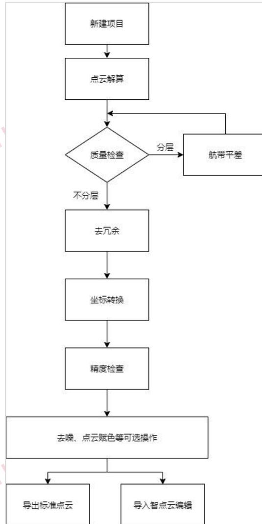
图 点云数据预处理流程图
