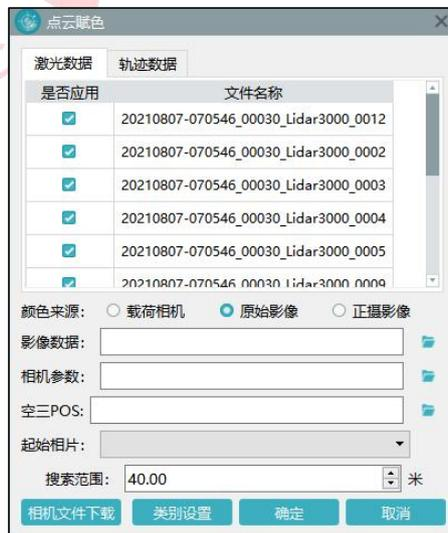
图 基于原始影像进行点云赋色
