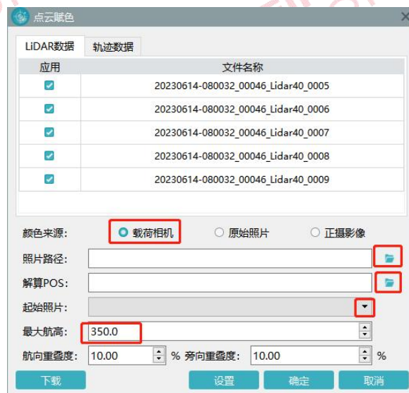
图 使用载荷相机赋色
