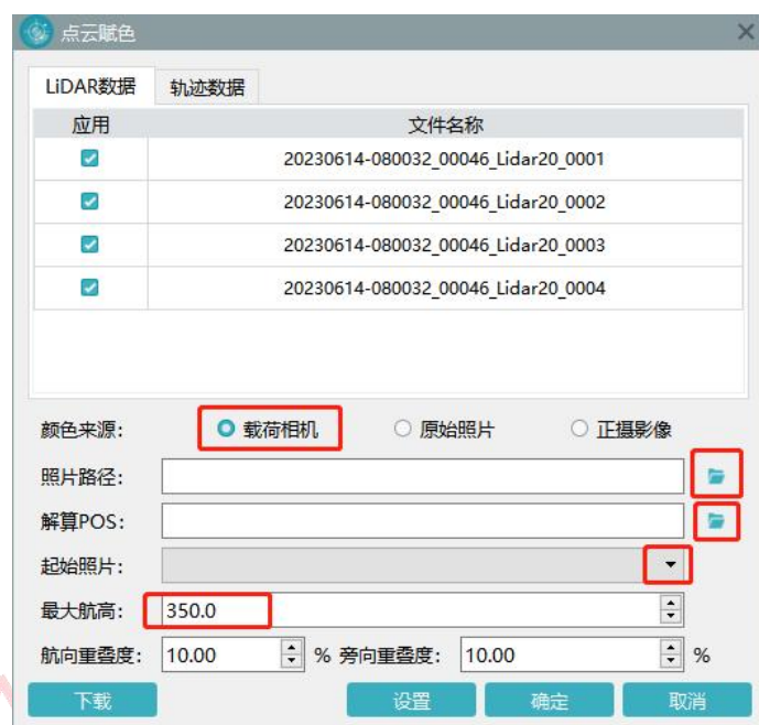
图 使用载荷相机赋色
