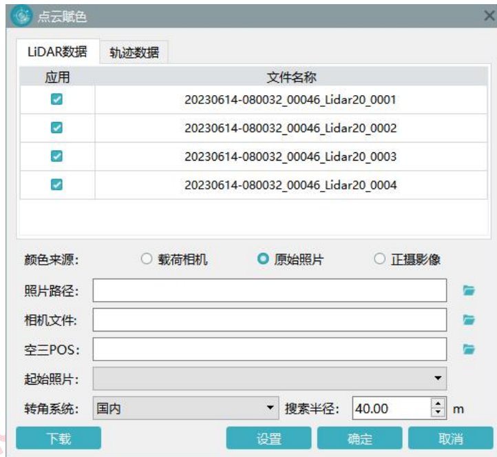
图 基于原始影像进行点云赋色
