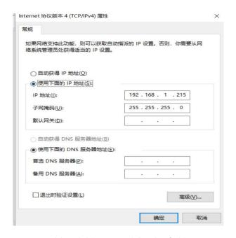
4、设置好地址后,关闭电脑的wifi,全景相机连接电源,使用转接 线连接网线在连接电脑。
