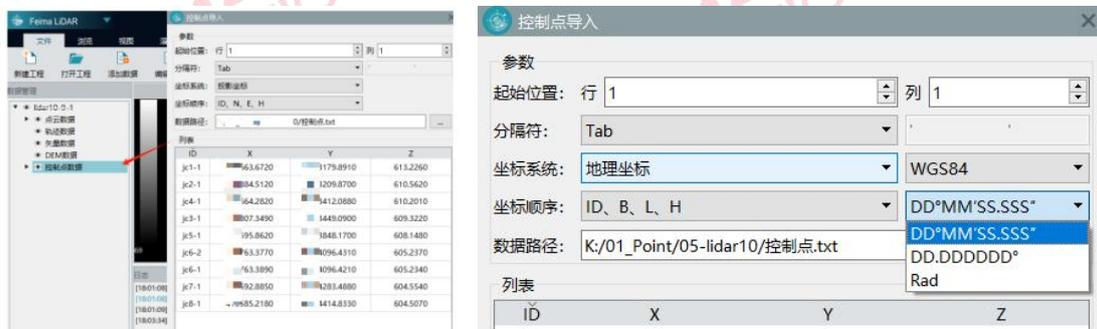
在控制点导入界面可以输入已知的控制点坐标，并可以按照控制点文件属性设置分隔符、坐标系统、坐标顺序等参数。其中的坐标系统支持投影坐标和地理坐标，地理坐标支持设置坐标系和坐标格式，如上图所示。
