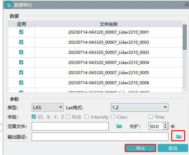
如果有后续编辑需求，可以不输出 LAS 数据，在【智点云】中打开\*.fmp 工程进行点云编辑操作。
