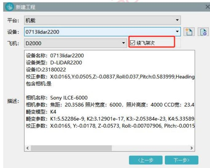
2) 选择差分模式为融合差分模式，添加对应的 RTK 文件、基站数据、流动站数据、IMU 数据和激光数据（激光数据格式.lvx），添加后点击架次 2，将续飞架次数据进行添加，完成后点击【完成】，完成新建项目。
