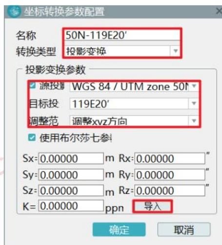
图 投影变换坐标转换设置
