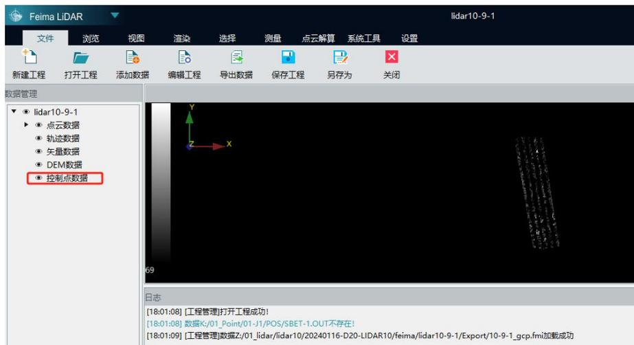
右击“控制点数据”弹出“控制点导入”对话框：
