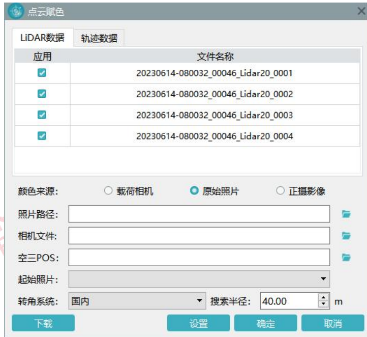
图 基于原始影像进行点云赋色
