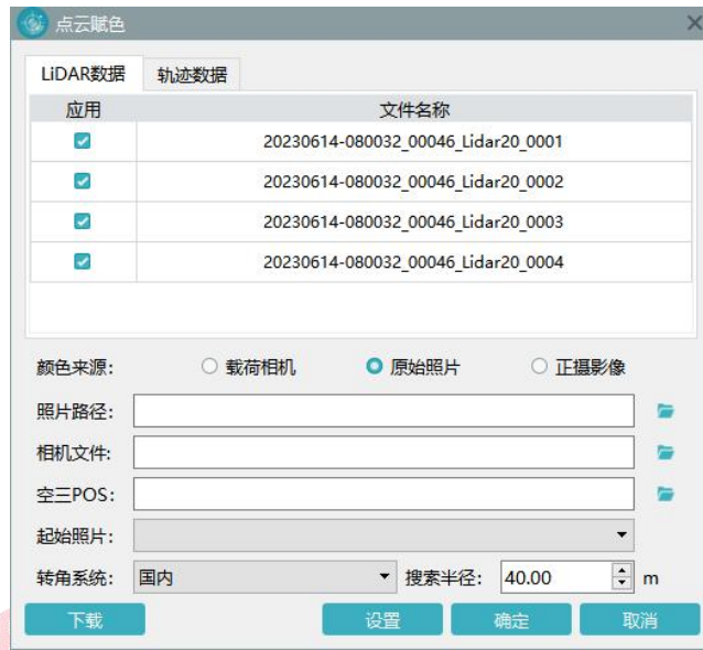
图 基于原始影像进行点云赋色
