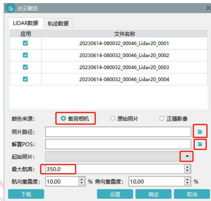
图 使用载荷相机赋色
