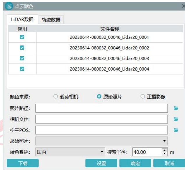
图 基于原始影像进行点云赋色
