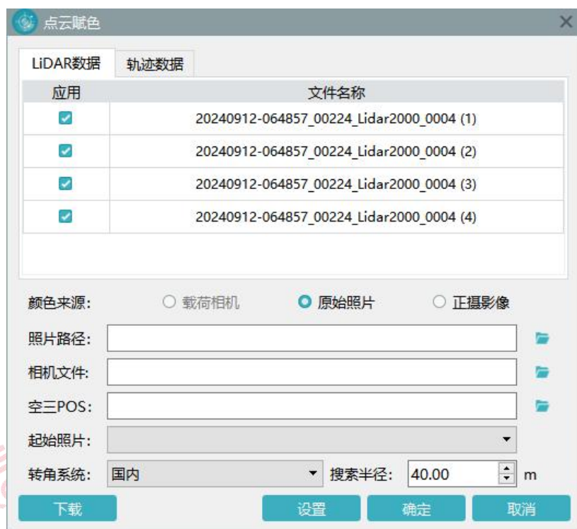
图 基于原始影像进行点云赋色
