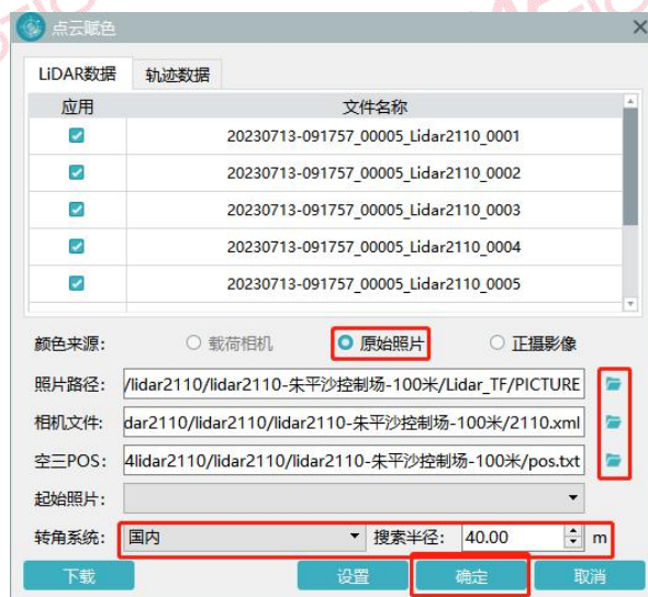
图 基于原始影像进行点云赋色
