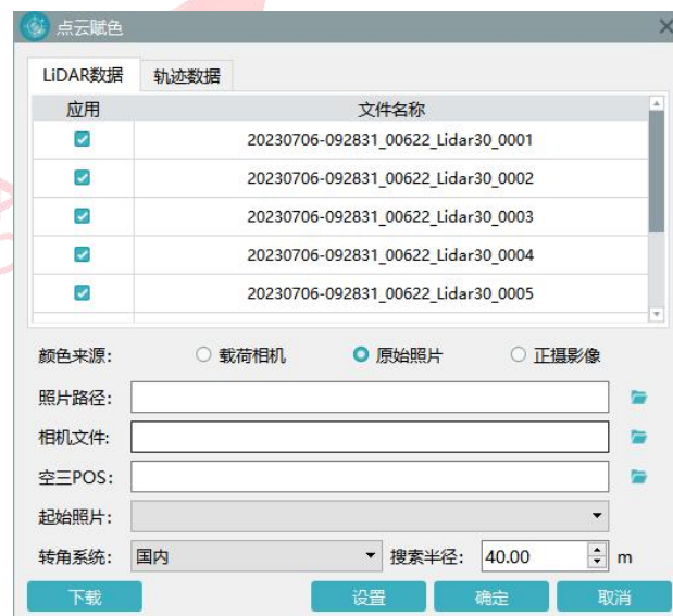
图 基于原始影像进行点云赋色
