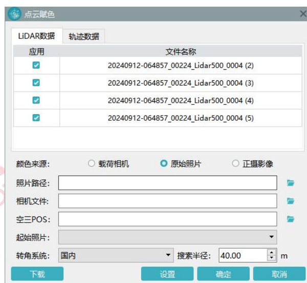
图 基于原始影像进行点云赋色
