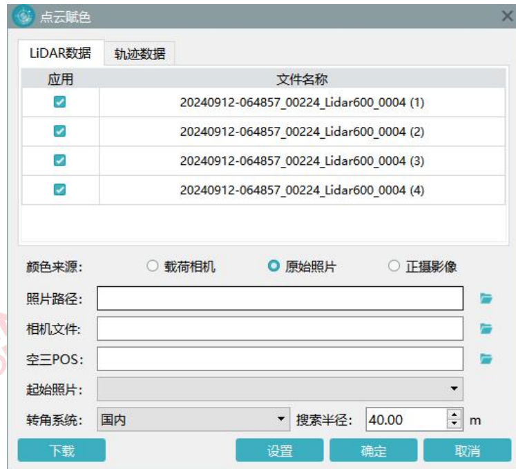
图 基于原始影像进行点云赋色
