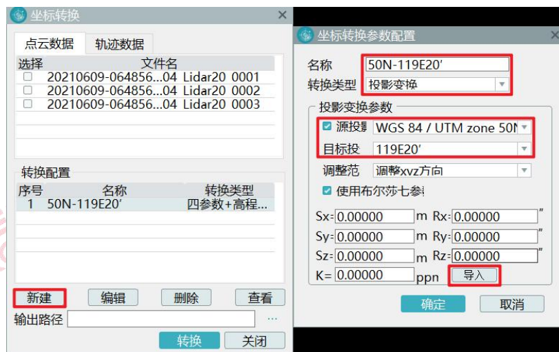
图 投影变换坐标转换设置
