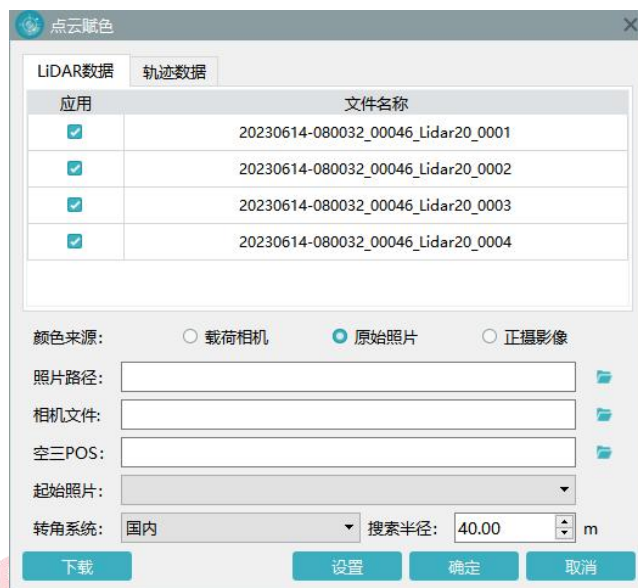
图 基于原始影像进行点云赋色
